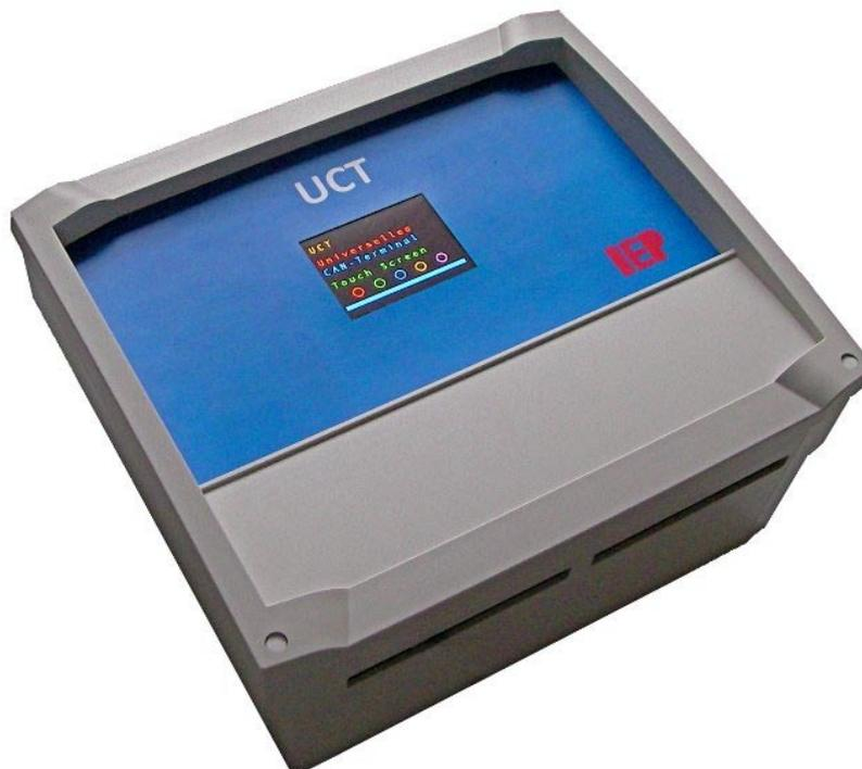
Die **UCT** ist eine Kleinsteuerung für den Vor-Ort-Einsatz im Niederspannungsbereich, z.B. für Heizungs- und Klimaregelungen. Zu Visualisierung und Bedienung dient ein OLED-Display mit Touchscreen, CAN bindet die UCT in ein Steuerungsnetz ein und ermöglicht den Anschluß weiterer I/Os.
