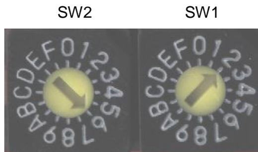
Es ist 62 eingestellt, binär 0110 0010. Die beiden oberen Bits zur Auswahl der Baudrate stehen also auf 01, d.h. es sind 125 Kbaud ausgewählt. Die BasisID ergibt sich zu:
