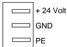
Die Baugruppe ist gegen Verpolung der Speisespannung geschützt. Als Steckverbinder wird der Typ MSTB 2,5/3-ST-5,08 der Firma Phoenix Contact eingesetzt.
